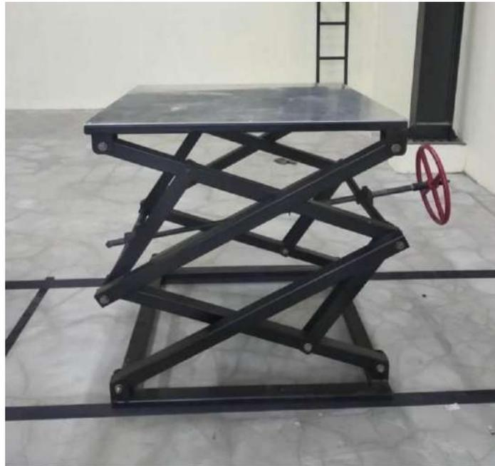
Gambar 5. Desain pengangkat sumber iradiasi
