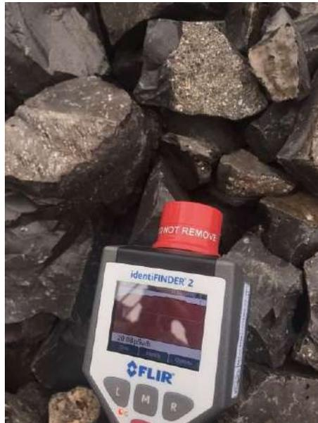
Gambar 2. Laju paparan pada residu slag pengolahan timah pada gambar 1 menunjukkan laju dosis 20,08 microSievert/jam
