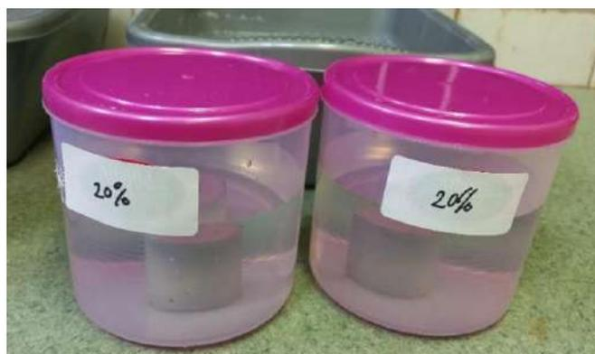
Gambar 4. Perendaman Mortar dalam Rangka Simulasi Pelindian
